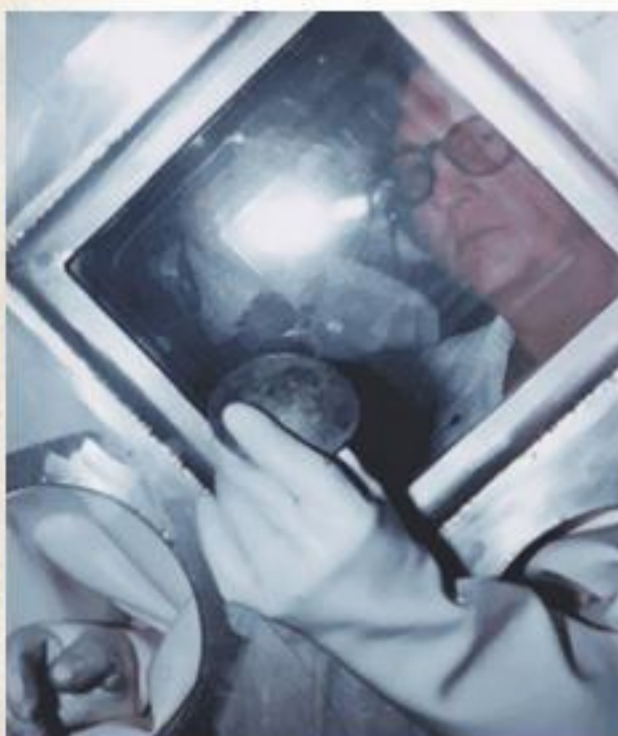
В такой камере человек при помощи защитных перчаток работал с плутонием. В одной из них и вспыхнул пожар.
