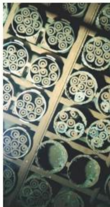
Отработанное ядерное топливо. От камеры его отделяют несколько метров чистой воды.
